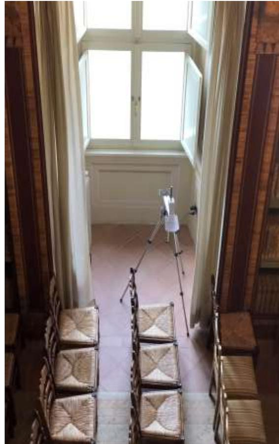
Datalogger e sonda per il monitoraggio della CO<sub>2</sub>.
